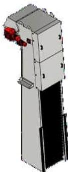
O princípio de funcionamento baseia-se numa face filtrante que é atravessada pelo efluente a ser filtrado, a face filtrante move-se quando é detetado um aumento da perda de carga, a movimentação da face filtrante proporciona uma diminuição da perda de carga e o tamisador volta a parar, esperando por novo aumento da perda de carga para voltar a arrancar.
